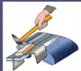
Гибка тонколистового металла в оправках, зажатых в тисках
