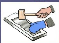
Правка тонколистового металла на плите киянкой
