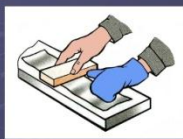
Правка тонколистового металла на плите деревянным бруском
